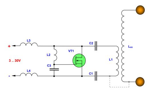
Параметры L3, L4 такие же, как и в схеме *DigitalM-3-4*. C1, C2 – 5,6нФ, 1600B. C3 – 10нФ, 1000B. L2 – 4мкГн (импортная индуктивность, провод 0,5). VT1 – STW26NM60, IRFP450, IRFZ34. Класс A-B.
