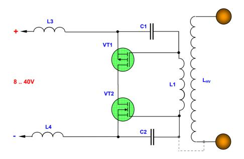
Параметры L1, L3, L4 такие же, как и в схеме *DigitalM-3-4*. C1, C2 – 10нФ, 1000В. VT1 – IRF9640. VT2 – IRF640. Класс A-B.
