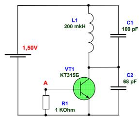
Запускается подачей положительного импульса в точку «А». Катушка на стандартном феррите «бочка» 8х10мм (импортные индуктивности). Конденсаторы усиливают излучение и не являются обязательными. Класс А.
