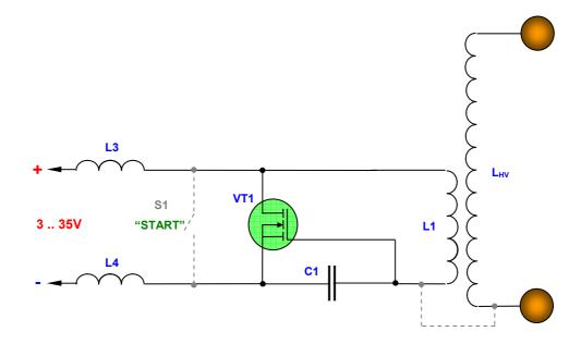
L1 — 4 витка d=4mm (AI), D=100mm. Намотано соленоидом или бифиляром Тесла. C1 — 5.6 нФ на 1600B. L3, L4 — фильтр питания UU9.8LF-182-LF (вторая обмотка включена задом наперед). VT1 — STW26NM60 (рекомендуется). Класс A.
