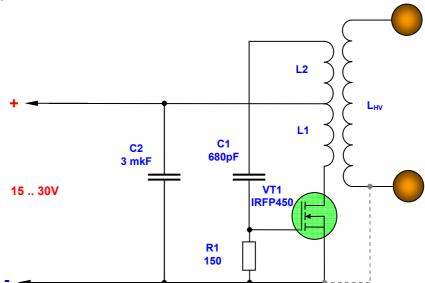
L1, L2 – одна катушка. 2(L1) + 4(L2) витка d=3mm (AI), D=100mm. Запуск импульсом 5B на затвор транзистора. Класс A.
