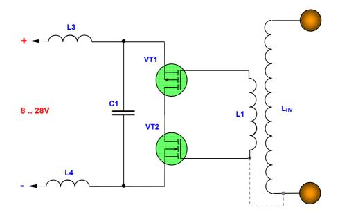
Параметры L1, L3, L4 такие же, как и в схеме *DigitalM-3-4*. C1 – 5,6 нФ, 1600B. VT1 – IRF9640. VT2 – IRF640. Класс C.
