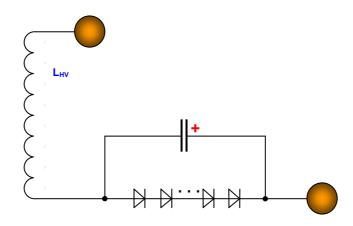
К выводу ВВ катушки подключен диод, к концу диода подключена электростатическая емкость. На диоде возникает напряжение. Подключенный параллельно диоду конденсатор заряжается. Чем больше последовательно включенных диодов, тем большее напряжение они создают. При стримере в 5мм мне удалось собрать банк в 15КВ и чувствую, что это не предел. Встречный диод внутри этой цепи тоже дает, но встречное напряжание.
