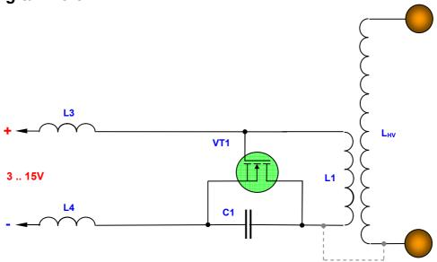
Параметры L1, L3, L4 такие же, как и в схеме *DigitalM-3-1*. C1 – 5,6 нФ, 1600B. VT1 – STW26NM60. Класс C.
